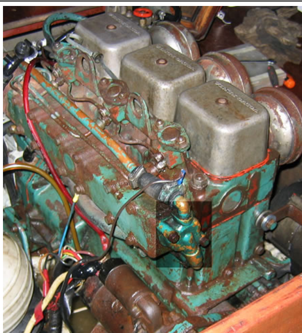
Termostatas variklyje Volvo MD3.
