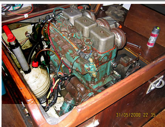
Variklio skyrius. Kairėje – tepalo siurblys, kuris puikiai tiko ne tik tepalui, bet ir triumo vandeniui pumpuoti.
